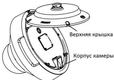
Рисунок 2-17 Верхняя крышка камеры PanoVu
