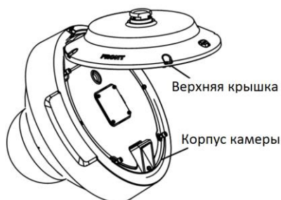
Рисунок 2-10 Верхняя крышка камеры PanoVu
