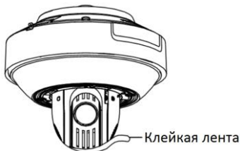
Рисунок 2-15 Удаление клейкой ленты
