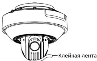
Рисунок 2-8 Удаление клейкой ленты
